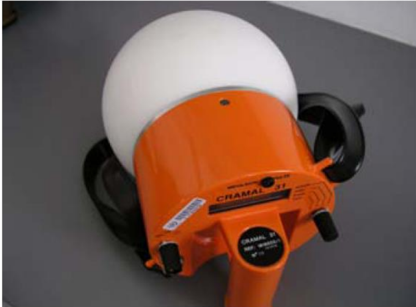
Miernik mocy równoważnika dawki dla neutronów z polietylenową otoczką termalizującą o średnicy 20 cm.
